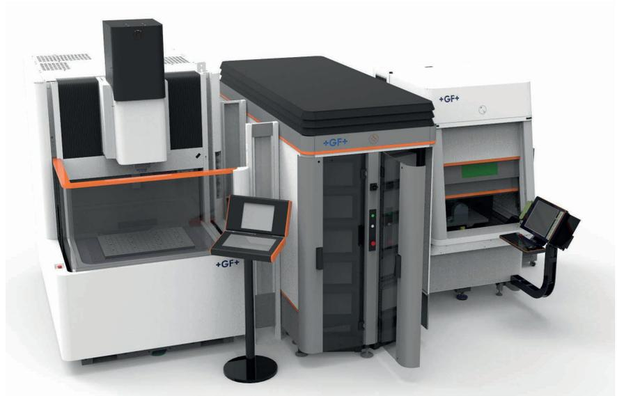
**Leistungsbeweis:** Auf der Fachmesse EMO in Mailand 2021 demonstrierte das Unternehmen GF Machining Solutions die Flexibilität der WPT 1+-Systeme am Beispiel einer Kombination aus 'Form-X-600'-Senkerodiermaschine (links) und digitaler Flexipulse-Texturiermaschine 'Laser P 400 U' © GF Machining Solutions
